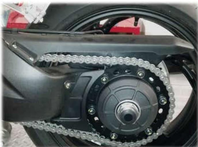
REMOVE THE ORIGINAL SCREWS ALONG THE FORK
